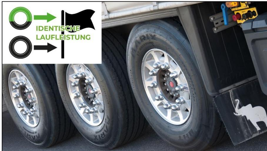
In Europa runderneuerte Lkw-Reifen erfüllen die gleichen Qualitätsstandards wie Neureifen (ECE-Normen 108 und 109). Für runderneuerte Reifen sind die gleichen Tests obligatorisch wie für Neureifen. Demzufolge ist die Sicherheit nicht nur vergleichbar, sondern identisch. Für die Runderneuerung mit qualitativ hochwertigen Gummimischungen werden nur sorgfältig geprüfte Qualitätskarkassen von Premium- und Qualitätsreifen zugelassen. Bild: Marangoni.
