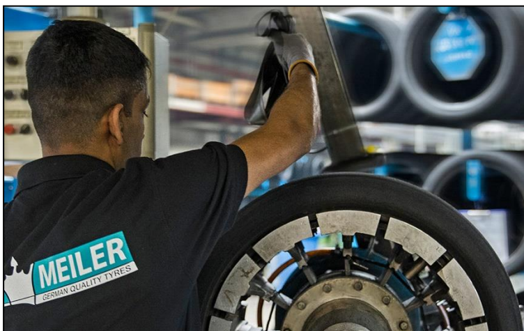
Abbildung 2: In einem Arbeitsgang werden Gummimischungen ausgezeichneter Qualität, optimiert auf die jeweilige Reifennutzung (Winter, Sommer etc.), von Extrudern geknetet und im erhitzten Zustand durch einen Spritzkopf gepresst. Die angeschlossene Belegevorrichtung bringt den Gummi auf die zuvor präparierten Karkassen auf. Je nach Anforderung enthalten die Compounds aus speziell entwickelten Mischungen heute kaum bis gar keinen Naturkautschuk, jedoch hohe Anteile Silica. Bildquelle: REIFEN HINGHAUS® GmbH.
