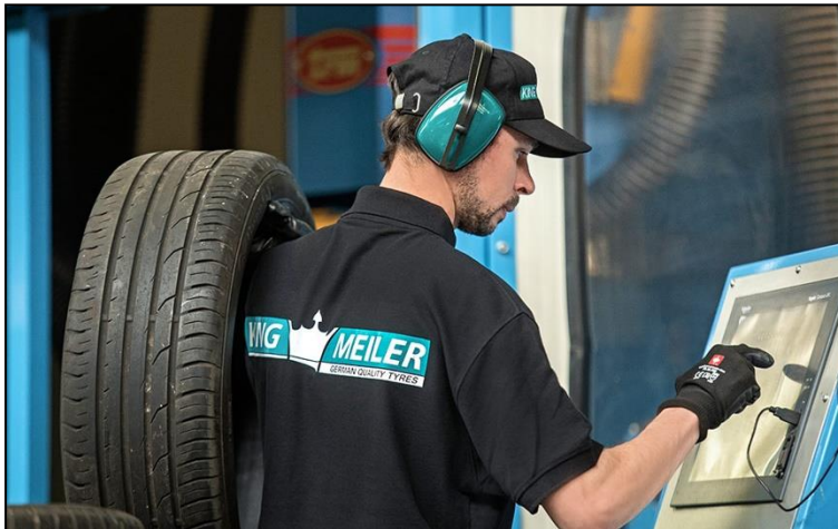
Abbildung 1: Bei der Runderneuerung werden Lauffläche und Seitenflanken in hochmodernen Raumaschinen computergesteuert abgeraut und auf eventuell noch vorhandene Unwuchten kontrolliert. Reifen, die sich außerhalb der Toleranzwerte bewegen, werden umgehend aussortiert. Bildquelle: REIFEN HINGHAUS® GmbH.
